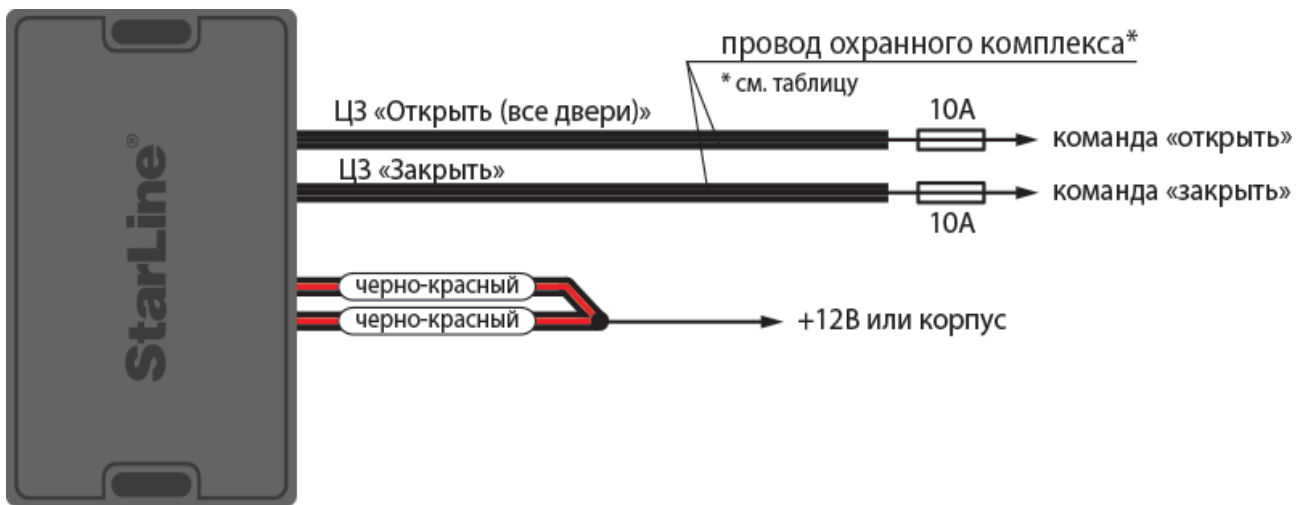
Схема аналогового подключения центрального замка с положительным или отрицательным силовым управлением для охранных комплексов StarLine A96/A66, B96/B66, D96/D66, AS96 (v2)
