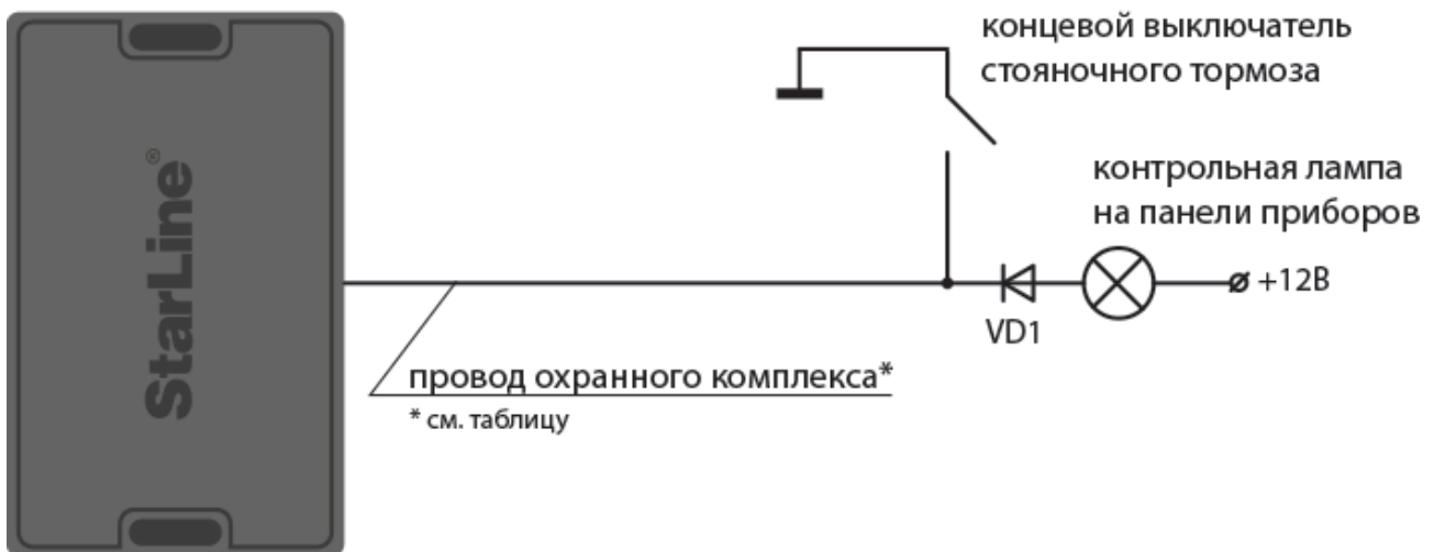
Схема подключения стояночного тормоза
