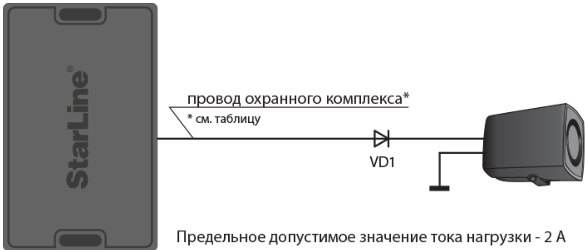
Схема подключения автомобильной сирены
