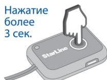
2. Последуют желтые вспышки, сопровождающиеся звуковыми сигналами. Отсчитайте количество вспышек, равное **первой цифре сервисного кода** и коротко нажмите кнопку модуля индикации. Ввод первой цифры завершен.
