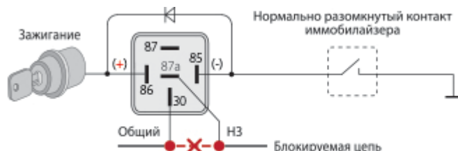
Подключение внешнего реле блокировки
