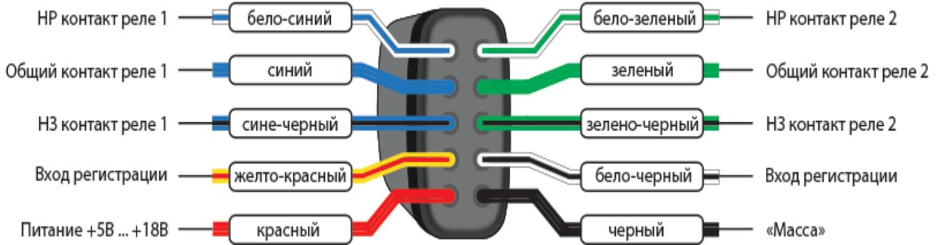
ⓘ При параллельном соединении двух контактных групп обоих реле максимально допустимый ток будет не более 1А.
