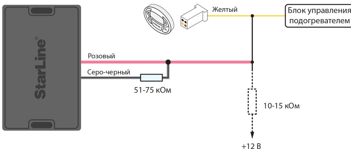
**Схема подключения предпускового подогревателя Webasto для охранных комплексов X96 (v2), A96/A66, B96/B66, D96/D66, E96/E66, S96/S66, AS96 (v2)**
