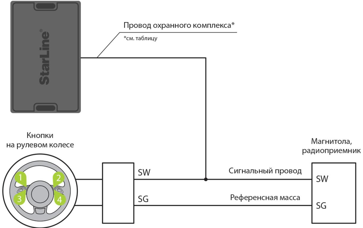
**Схема подключения аналоговых кнопок для охранных комплексов StarLine A96/A66, B96/B66, D96/D66, AS96(v2)**
