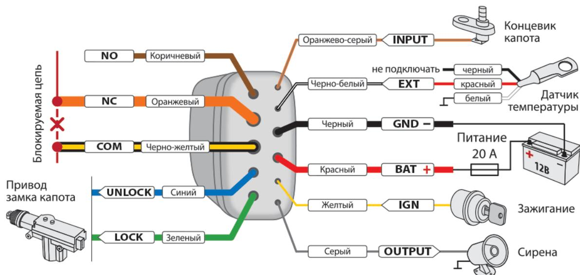
Схема подключения подкапотного блока **StarLine R6**4.12.5 Подключение цифрового микрореле **StarLine R6 ECO**
